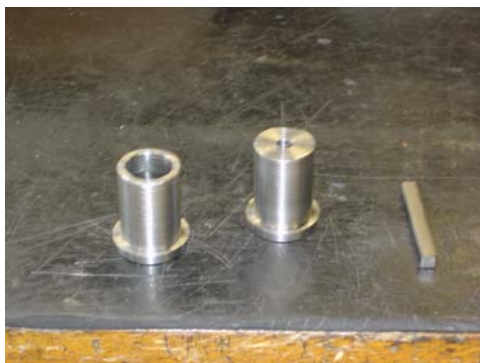
Figura 12.1: Buchas da roda e chaveta de fixação.
