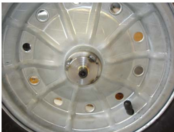
Figura 12.5: Roda já fixada, com auxílio do parafuso e pontos de solda.
